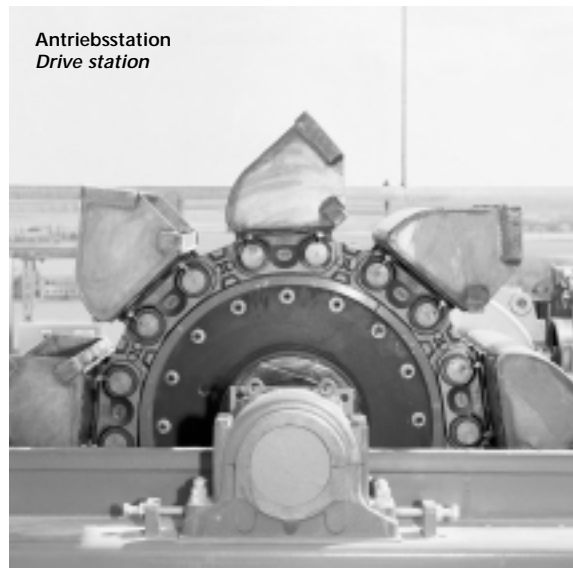
Optimierung des Verschleißvolumens durch den schwimmend gelagerten Bolzen Optimum wear volume due to free floating pin
